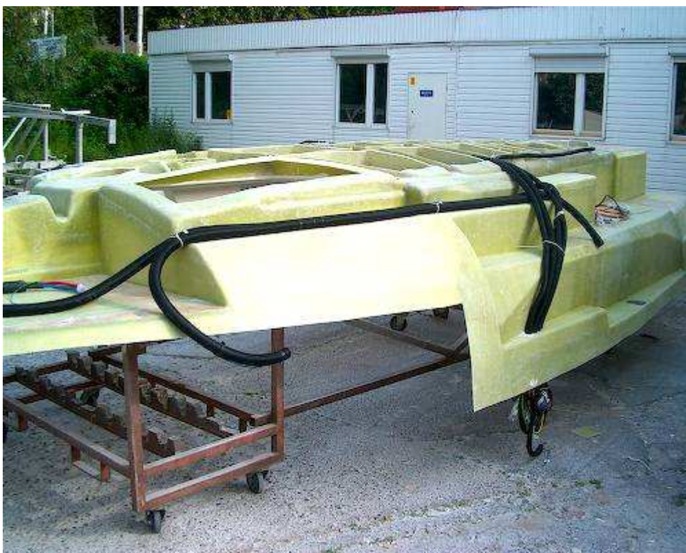
Montaż kabli w module
