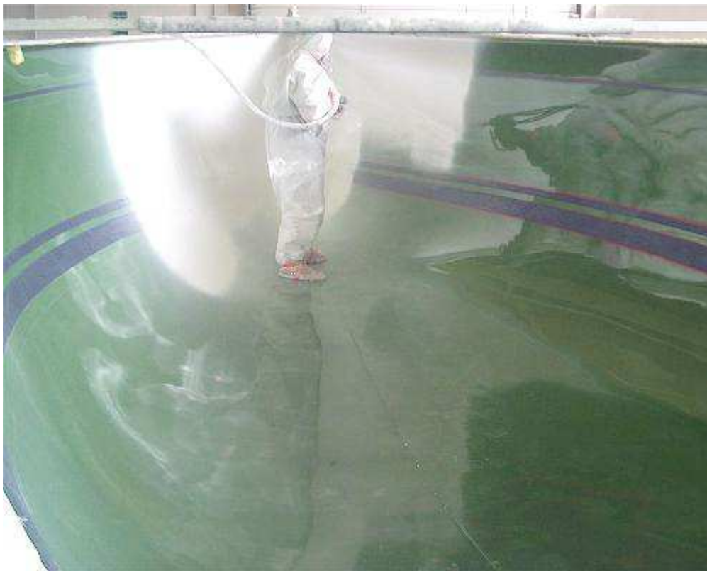
Natrysk żelkotu na formie kadłuba Oczywiście wcześniej kładzie się wosk!
