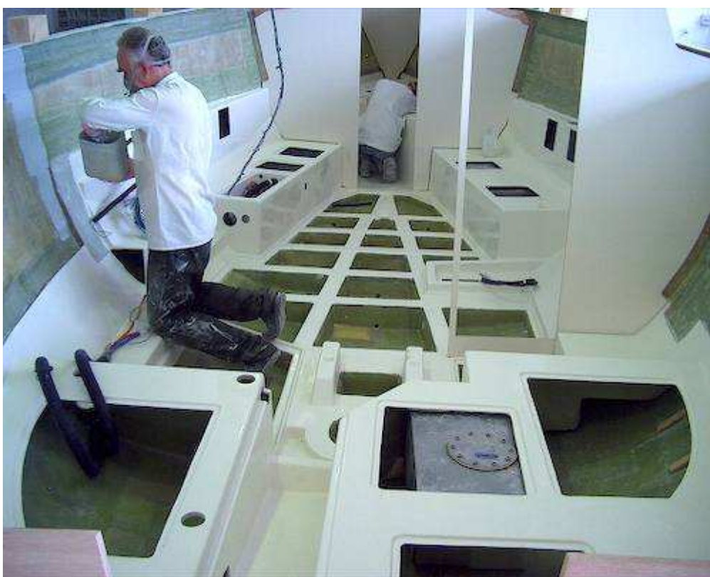
Montaż modułu w kadłubie
