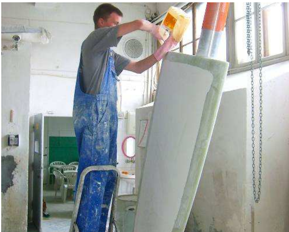
Zalewanie pianą pletwy (wzmocnienie + pływalność)
